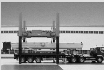
⑪セット装置下げ操作及びジャッキ下げ操作を行い、トレーラに載せる。
