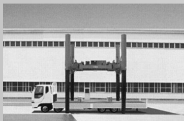
④ジャッキを全伸長し、リフター搬送用トラックを外す。（ラジコンにて地上より操作）
