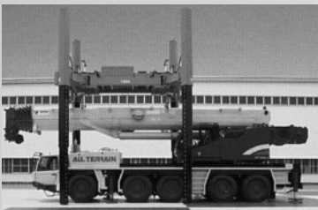
⑦セット装置でブームを上げ、その後ジャッキを全伸長させる。
